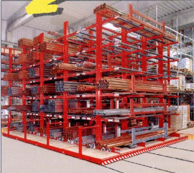
Kragarmregal für Lagergut im Baubeschlaghandel
